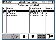
Anzeige der konfigurierten Alarme und deren aktueller Status wird in Form einer Tabelle dargestellt.
