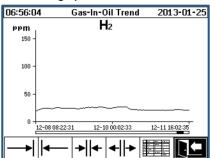
Der Messwert, in diesem Fall Wasserstoff  $(H_2)$ , wird als graphischer Zeitverlauf dargestellt.
