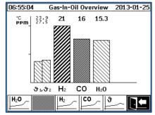
Balkendiagram für Wasserstoff  $(H_2)$ , Kohlenmonoxid (CO), Ölfeuchte  $(H_2O)$  und Temperaturen
